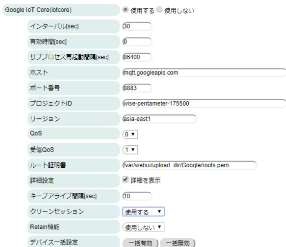
**インターバル[sec]** : 送信完了後～送信開始までの時間間隔を秒単位で設定します。
