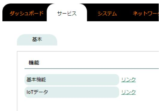
「サービス」→「基本」タブより「IoT データ」リンクをクリックすると、ルートタブが IoT データ制御の設定を行う「ダッシュボード」／「基本」／「IoT データ」に切り替わります。
