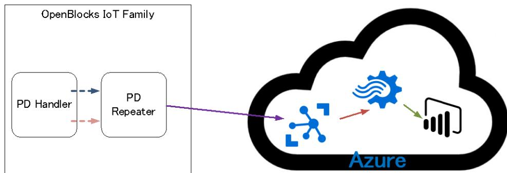
PD Repeater から Azure IoT Edge に送信する場合、ホストマシン(OpenBlocks)からホスト内に存在するコンテナまたはAzure IoT Edge が稼働している別のマシンに対してデータ送信を行います。Azure IoT Edge では、データのフィルタを行うコンテナを行うことでデータ処理が行えます。また、通常稼働ではオフライン環境での動作をサポートしております。IoT Hub へのデータ送信が必須ではありません。(コンテナのダウンロード及び構成変更等については IoT Hub との通信が必要となります。)
