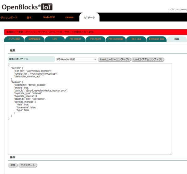
1. WEB UI の「IoT データ」→「編集」タブより、「編集対象ファイル」としてを「PD Handler BLE」を選択します。
