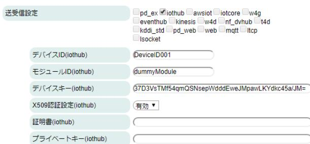
**デバイス ID(iothub)** : IoT Hub のデバイス ID を設定します。
