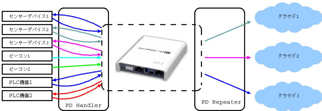
下流方向制御機能はクラウドから制御メッセージを受け取り、Modbus 対応 PLC 等を制御することができます。
