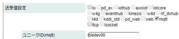
**ユニーク ID(mqtt)**：汎用 MQTT サーバーへデータを送る際、もしくは制御メッセージを受け取る際の MQTT プロトコルのトピックのサフィックスに用いる各デバイス毎にユニークな文字列を設定します。'.' (ASCII コード 0x2e) は '/' (ASCII コード 0x2f) に変換して扱われます。
