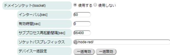
**インターバル[sec]** : 送信完了後～送信開始までの時間間隔を秒単位で設定します。
