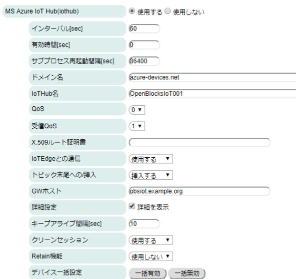
**インターバル[sec]** : 送信完了後～送信開始までの時間間隔を秒単位で設定します。
