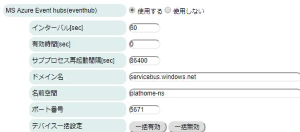
**インターバル[sec]** : 送信完了後～送信開始までの時間間隔を秒単位で設定します。
