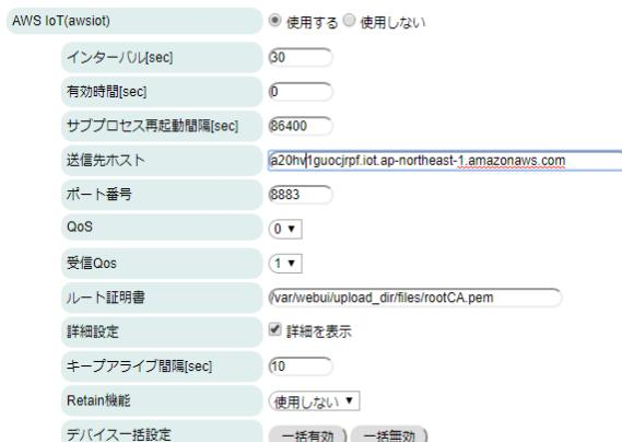
**インターバル[sec]** : 送信完了後～送信開始までの時間間隔を秒単位で設定します。
