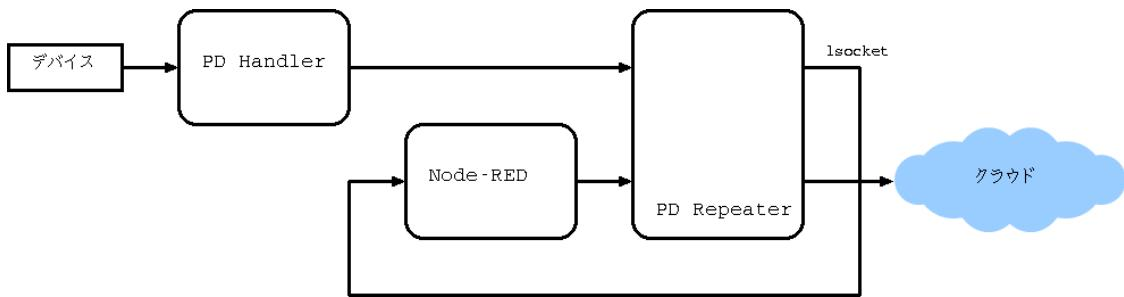
第 2-3 章に示すユーザー定義のコンフィグを使用し UNIX ドメインソケット名を変更することで、下図のようなよりスループットを意識した構成とすることが可能です。
