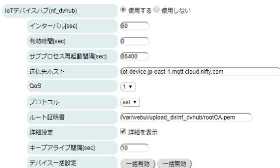
**インターバル[sec]** : 送信完了後～送信開始までの時間間隔を秒単位で設定します。
