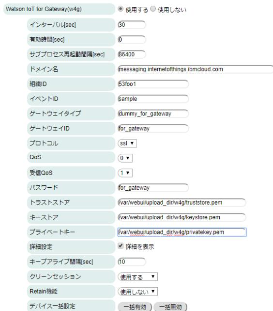
**インターバル[sec]** : 送信完了後～送信開始までの時間間隔を秒単位で設定します。
