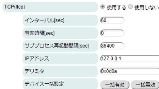
**インターバル[sec]**: 送信完了後～送信開始までの時間間隔を秒単位で設定します。
