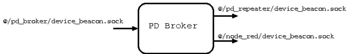
例えば、下図のように PD Handler BLE でビーコンを受け、Node-RED でフィルタリングし、PD Repeater を介し MQTT 接続でクラウドへデータ送る構成で、同じ MQTT 接続を用いて制御メッセージを受け取り Node-RED のフィルタリングパラメータと PD Agent を制御しようとする場合等に用いられます。
