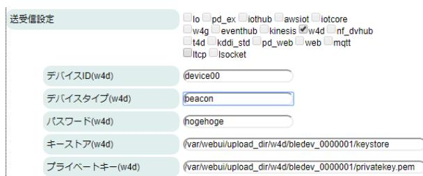
**デバイス ID(w4d)** : Watson IoT for Device のデバイス ID を設定します。
