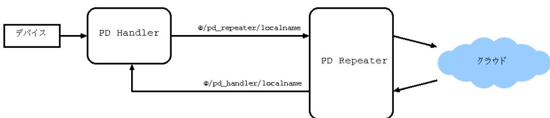
制御メッセージは JSON 文字列を想定していますが、クラウド側の制御要件としてペイロードに載せられない情報、MQTTにおいてはトピック、PD Exchangeにおいてはコマンド ID、PH 社独自仕様 WEB サーバーにおいては応答ヘッダー、TCP 接続においてはポート番号が必要となる場合が考えられるため、PD Repeater から下流のソフトウェアモジュールへの制御メッセージの転送においては、これらの情報と制御メッセージのハッシュ値(MD5)を付加しています。
