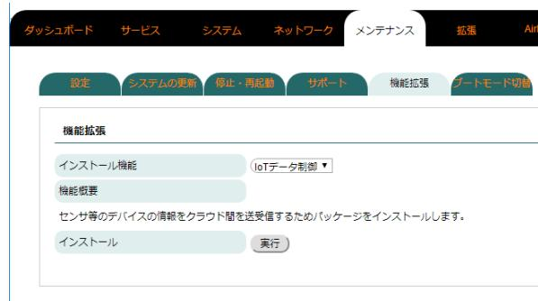
「メンテナンス」→「機能拡張」タブの「インストール機能」で「IoT データ制御」を選択し、「実行」をクリックします。IoT データ制御パッケージが既にインストールされている場合は、「インストール機能」の選択肢として「IoT データ制御」が表示されません。
