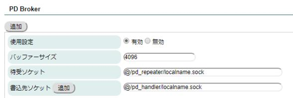
**追加**:複数の待受けソケットを設定する場合にクリックします。2個目以降の入力フォームが表示されます。
