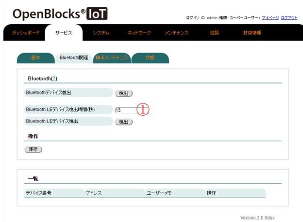
Bluetooth LE センサーデバイスの電源を入れ、「Bluetooth LE デバイス検出」の検出ボタン①を押してください。
