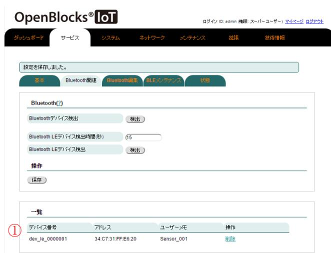
一覧に選択したデバイスが表示されていること①を確認します。
