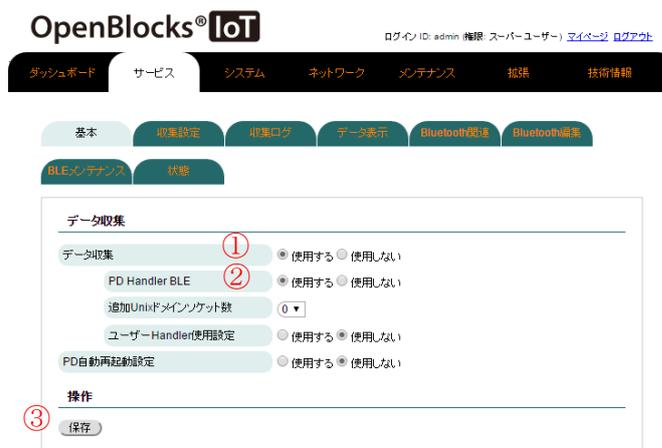
「データ収集」①と「PD Handler BLE」②を”使用する”に設定し、保存ボタン③を押してください。
