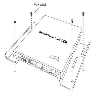
OpenBlocks IoT本体裏と放熱・設置ブラケットの それぞれ対角線にある2箇所の穴の位置を合わせ、 M3x5+セットナベ小ネジSW付を上から留めて取り付ける。
