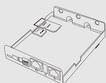
OpenBlocks IoT Family にて、搭載可能なSIM形状は mini-SIM (2FF)です。micro-SIM 及び nano-SIMを使用する場合には、脱落防止フィルム有及び接着テープ有でSIMを固定できるアダプタを使用してください。
