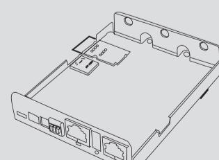
OpenBlocks IoT Family にて、搭載可能な SIM 形状は mini-SIM(2FF) です。micro-SIM 及び nano-SIM を使用する場合には、脱落防止フィルム有及び接着テープ有で SIM を固定できるアダプタを使用してください。尚、SIM アダプタを使用した場合での SIM スロットの破損は有償修理対象となります為、ご注意ください。
