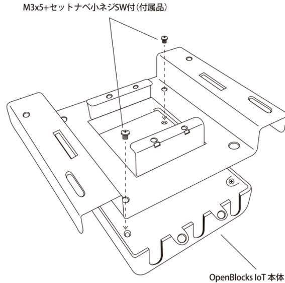
OpenBlocks IoT VX1 または EX1 本体裏と放熱・設置ブラケットの対角線にある 2 箇所穴の位置を合わせ、M3x5+セットナベ小ネジ SW 付(付属品)を上から留めて取り付けます。
