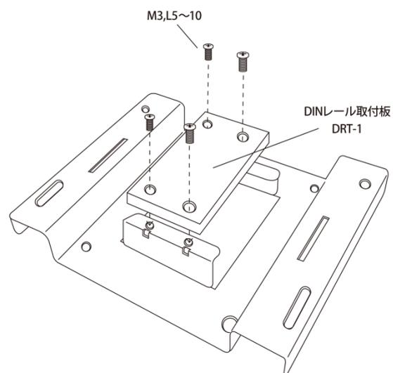
DIN レール取付板(DRT-1/別売り)と放熱・設置ブラケットを M3 L5~10 小ネジ<sup>※1</sup> を使用して取付けます。
