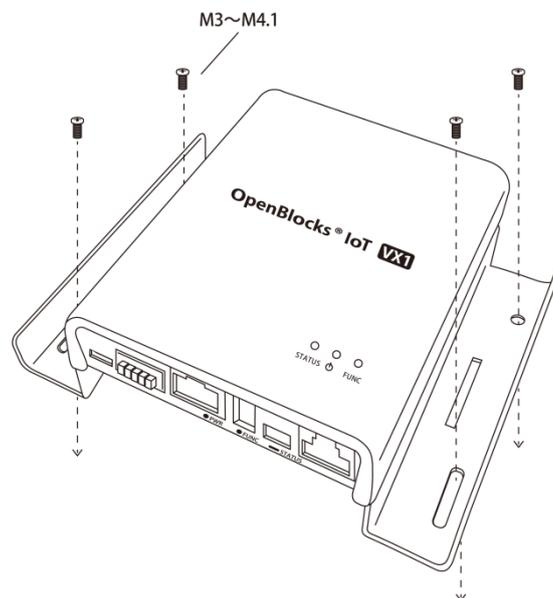
放熱・設置ブラケットを取付けた OpenBlocks IoT VX1 または EX1 を M3~M4 小ネジ<sup>※1</sup>または 3~4.1 タッピングネジ<sup>※1</sup>を使用して キャビネットや壁面に取付けます。
