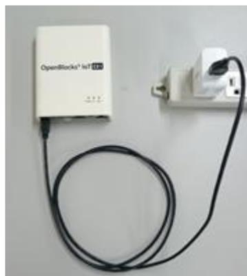
また、OpenBlocks IoT VX1 を添付の AC アダプタを用いて以下のように接続します。
