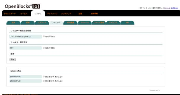
WEB UI の「システム」タブを選び、さらに「フィルター」タブをクリックすると SSH の開放/閉鎖の設定が表示されます。
