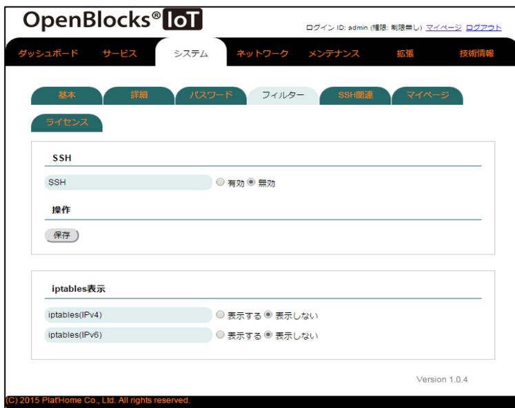
WEB UI の「システム」タブを選び、さらに「フィルタ」タブをクリックすると SSH の設定ペインが表示されます。
