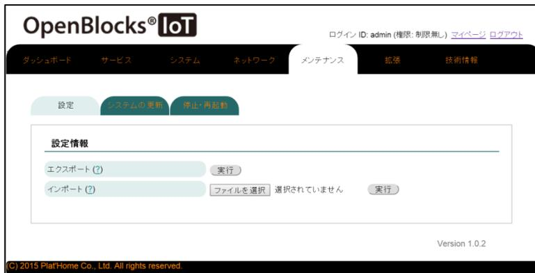
この画面で OpenBlocks IoT に設定したコンフィグレーションファイルを WEB 接続している PC に対してバックアップ・リストアします。エクスポートの実行ボタンを押すと、PC のダウンロードフォルダにコンフィグレーションファイルのバックアップをダウンロードします。設定をリストアする時には、インポートのファイル選択で、バックアップファイルを選び、実行ボタンを押すとコンフィグレーションファイルがリストアされます。
