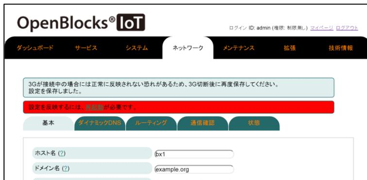
ネットワークの基本設定後、保存ボタンを押した状態になると、WEB画面の上部にシステム再起動を促すメッセージが左図の通り表示されます。
