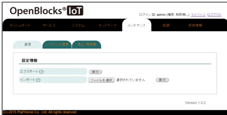
この画面で OpenBlocks IoT に設定したコンフィグレーションファイルを WEB 接続している PC に対してバックアップ・リストアします。エクスポートの実行ボタンを押すと、PC のダウンロードフォルダにコンフィグレーションファイルのバックアップをダウンロードします。設定をリストアする時には、インポートのファイル選択で、バックアップファイルを選び、実行ボタンを押すとコンフィグレーションファイルがリストアされます。
