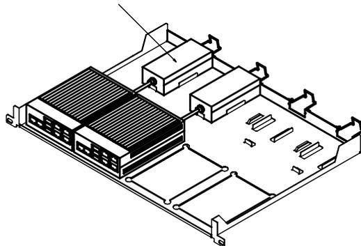
3. 上ケースを図のネジ穴を使用して、ラックに取り付けます。
