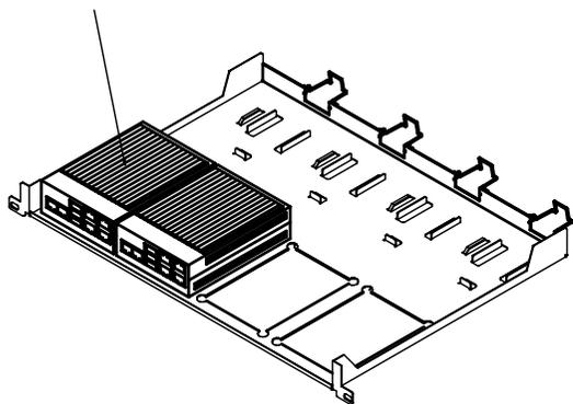
2. ACアダプターを下ケースの枠に合わせて乗せ、DCコードをOpenBlocks本体に接続します。余ったDCコードは束ねてクランプに固定します。
