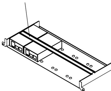
3. 上ケースを図のネジ穴を使用して、ラックに取り付けます。
